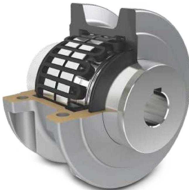
As grades do acoplamento T possuem secção trapezoidal e são fabricadas em aço ligado de alta resistência temperadas e revenidas para dureza de molas. A superfície é então jateada com micro esferas de aço com grande precisão de operação denominada de “Shot peening” que comprimem as moléculas da superfície por trabalho mecânico.
