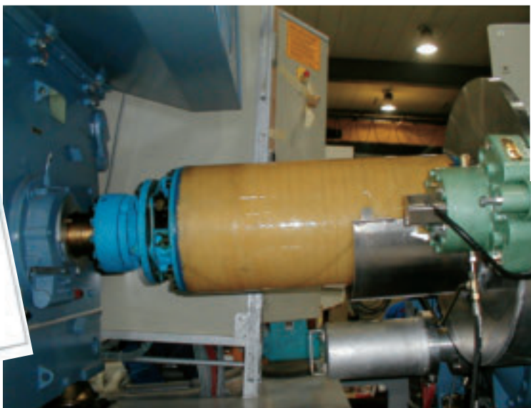
Lamidisc SXGF-302-6/752 MM con eje de fibra de vidrio para Aerogeneradores.
