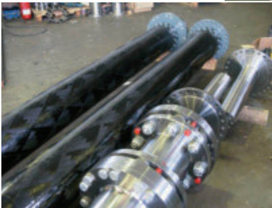
Lamidisc® DOAE-475-8 - CFRP: para líneas de ejes de ferry rápido
