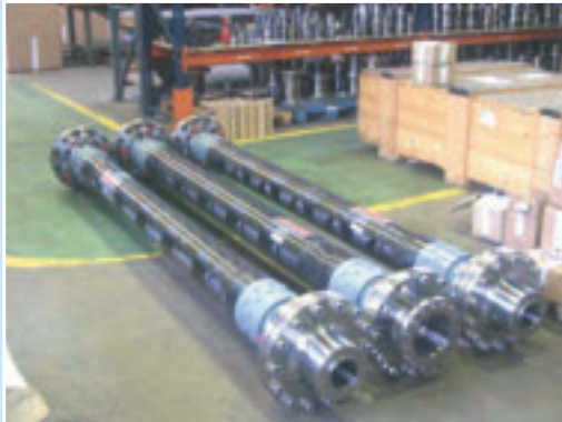
Lamidisc® DOAE-345-8 CFRP: para patrulleras aplicación naval
