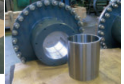
Cascillo cónico para desmontaje hidráulico.
