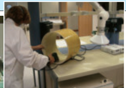
Preparación superficial del Eje de Composite.
